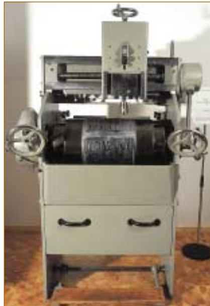
Mit dem Rundscharer wurden auf der Druckplatte nichtdruckende Stellen tiefer gefräst bzw. Farbseparationen vorgenommen.
