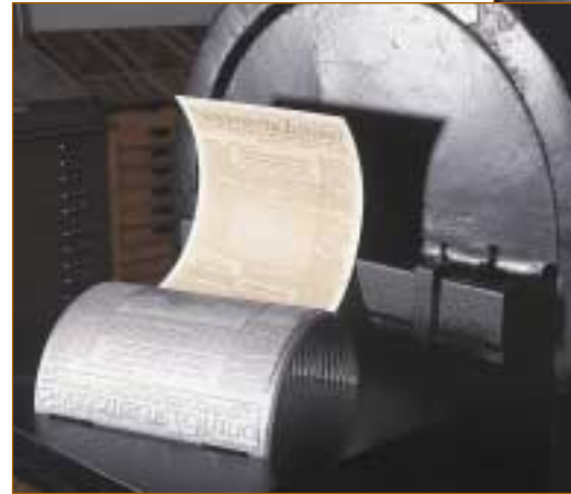
Geprägte, tiefgezogene Mater einer planen Bleiseite mit entsprechendem Rundstereo, auch Rundplatte genannt.
