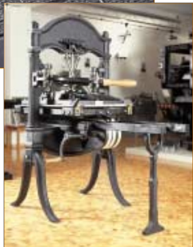
rechts: Kniehebelpresse, sog. »Deutsche Presse«. Hersteller: Fa. Mansfeld, Magdeburg. Baujahr etwa 1880.
